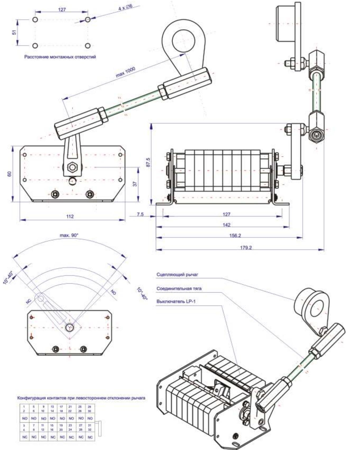
Конфигурация контактов при левостороннем отклонении рычага
